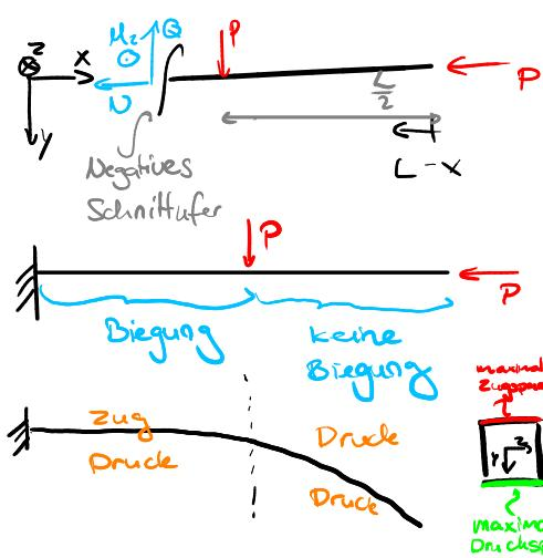
Superposition der Spannung durch Biegung und Normalkraft:
