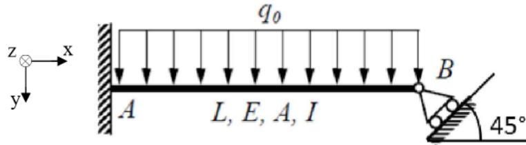
Man berechne den Betrag der Verschiebung des Punktes  $B$ .
