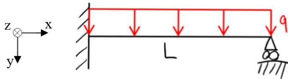
1. GGB lösen und alle Lagerreaktionen in Abhängigkeit der noch Unbekannten Lagerreaktion/-er setzen. Die Anzahl der Unbekannten ist gleich dem Grad der Unbestimmtheit. Die Unbekannten durch Randbedingungen der Biegelinie bestimmen.
