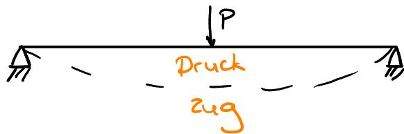
**Maximale Spannungen findet man**
