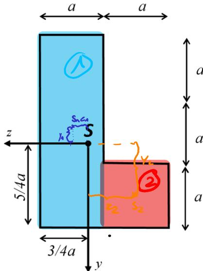
Für den dargestellten Querschnitt sind die Position des Schwerpunktes S und die Flächenträgheitsmomente  $I_z = \frac{37}{12}a^4$  und  $I_y = \frac{13}{12}a^4$  bekannt.
