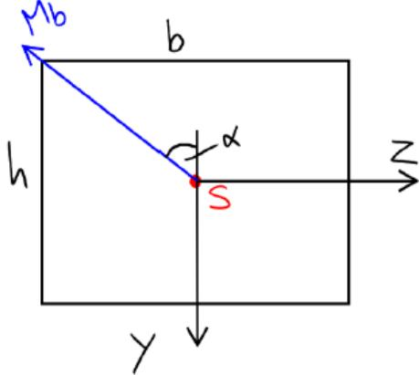
Man bestimme die maximale Normalspannung in dem auf schiefe Biegung belasteten rechteckigen Querschnitt.
