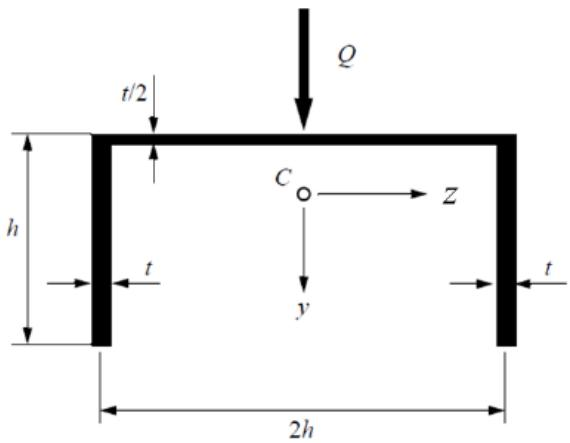
Man bestimme den Schubspannungsverlauf für den abgebildeten Querschnitt (dünnwandiges U-Profil) bei gegebener Querkraft  $Q_y$ . An welcher stelle die maximale Schubspannung  $|\tau|_{max}$  auf?
