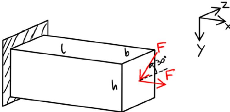
Man bestimme den maximal zulässigen Betrag  $F$  so, dass die maximale Normalspannung im Balken den Wert  $\sigma_{zul}$  nicht überschreiten wird.
