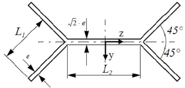
$$H_z(s) = \iint_{\Delta A} y \, dA = \underbrace{\iint_{\Delta A} y(\eta) \cdot e(\eta) \, d\eta}_{\text{alternative Schreibweise}} \xrightarrow{\text{für Rechtecke}} \underbrace{\int_0^s y(\eta) \, d\eta}_{\text{dünnwandige Profile}}$$
