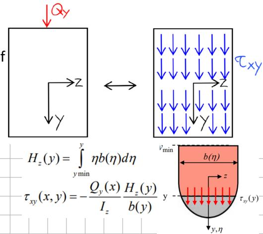
Das statische Moment hat keine direkte geometrische Bedeutung. Es ist ein Hilfsmittel zur Berechnung von anderen Größen. Bei dünnwandigen Querschnitten lassen sich Vereinfachungen treffen und das statische Moment lässt sich dann oft einfacher berechnen.
